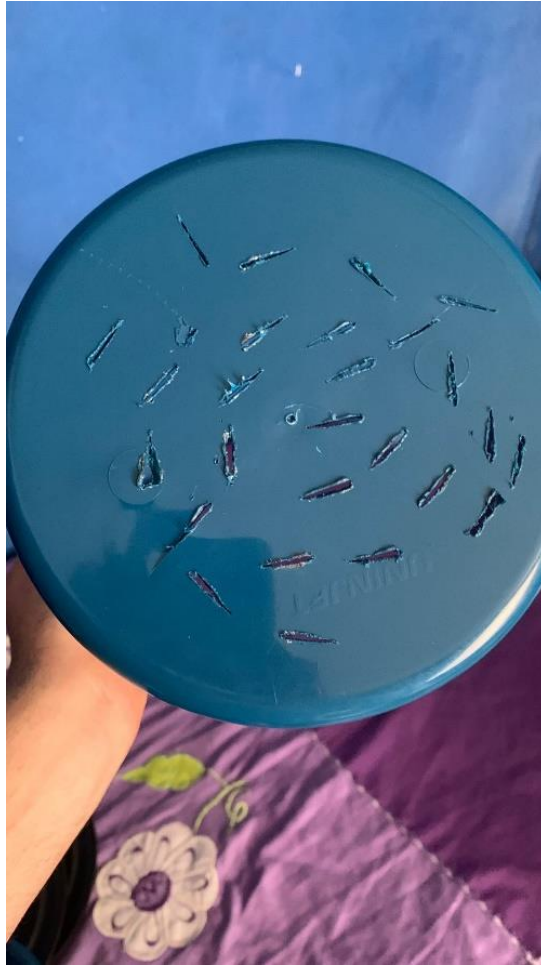
Figura 4. Furos na parte inferior do balde para ocorrer a liberação do chorume.
