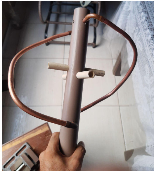
Figura 28 – Construção dos loops
