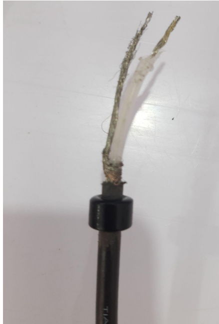
Figura 14 – Disposição dos anéis de ferrite nos dipolos e receptor
