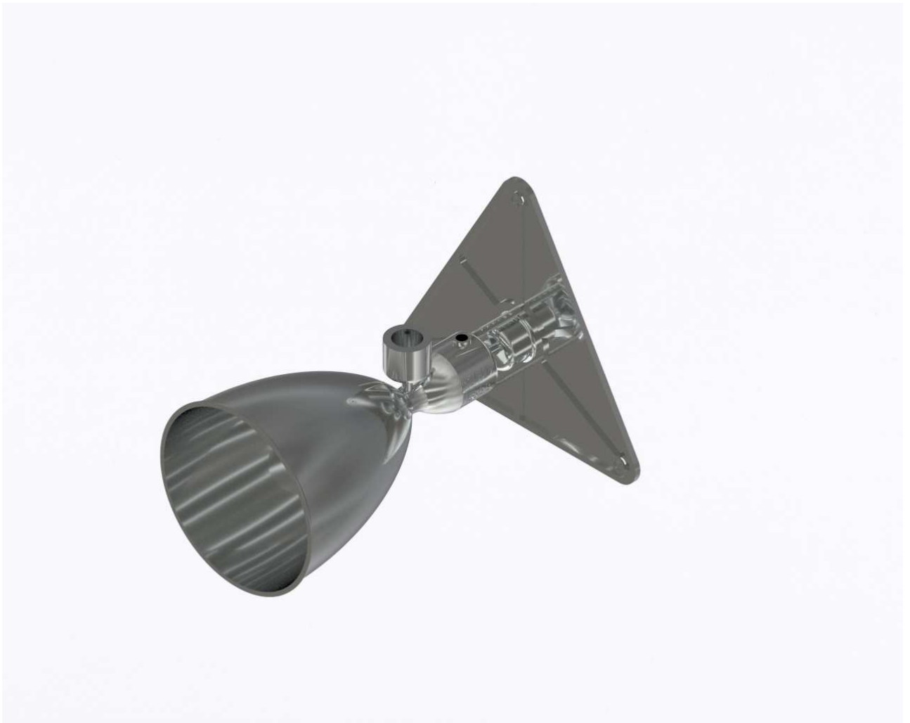
Figura 6.37 – Geometria otimizada do L22N desenhada no (INVENTOR, 2023), mais leve e utilizando o MOC na tubeira. Fonte: Autor.
