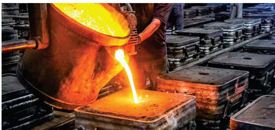
Figura 28 – Metal fundido sendo incluído no molde
