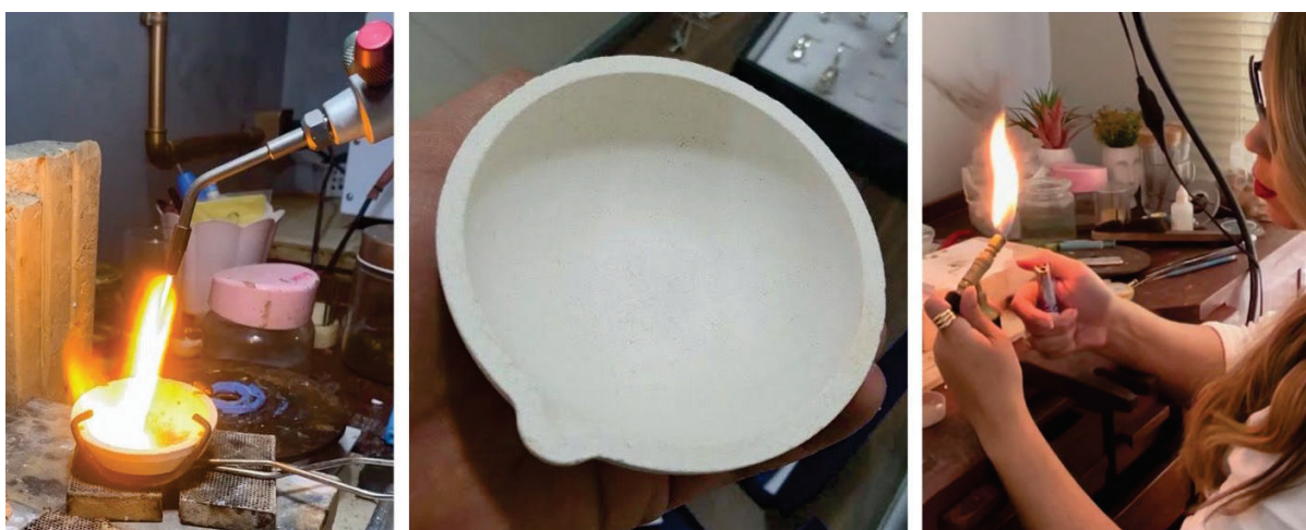
Figura 63 – Maçarico gás/oxigênio, cadinho cerâmico e maçarico ORCA
