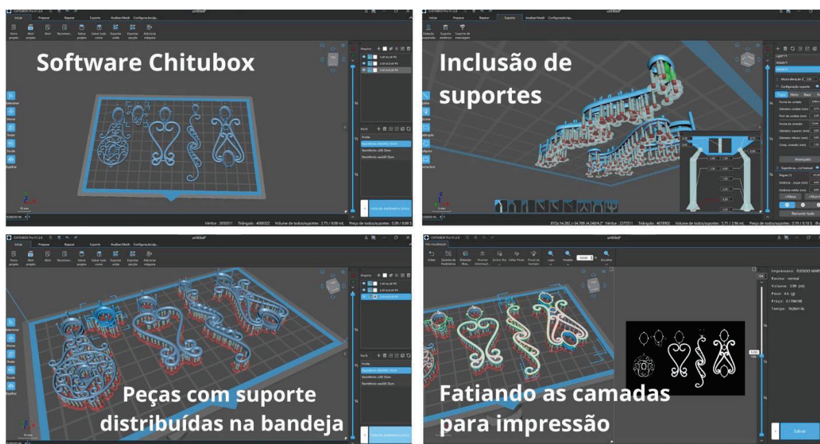
Figura 59 – Telas do software de fatiamento Chitubox
