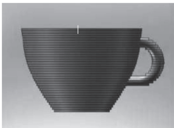
Figura 29 – Imagem de uma xícara com as camadas construtivas aparentes
