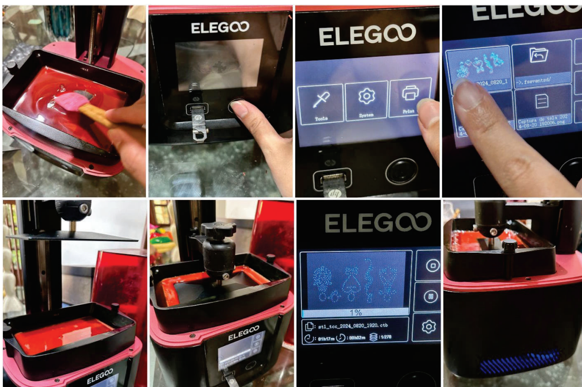
Figura 60 – Sequência de processos para início da Impressão 3D
