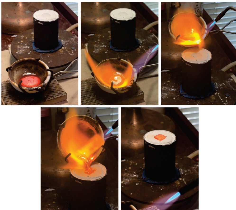
Figura 66 – Prata derretida no cadinho e tubo de gesso na base de vácuo; Prata sendo vertida no tubo de gesso
