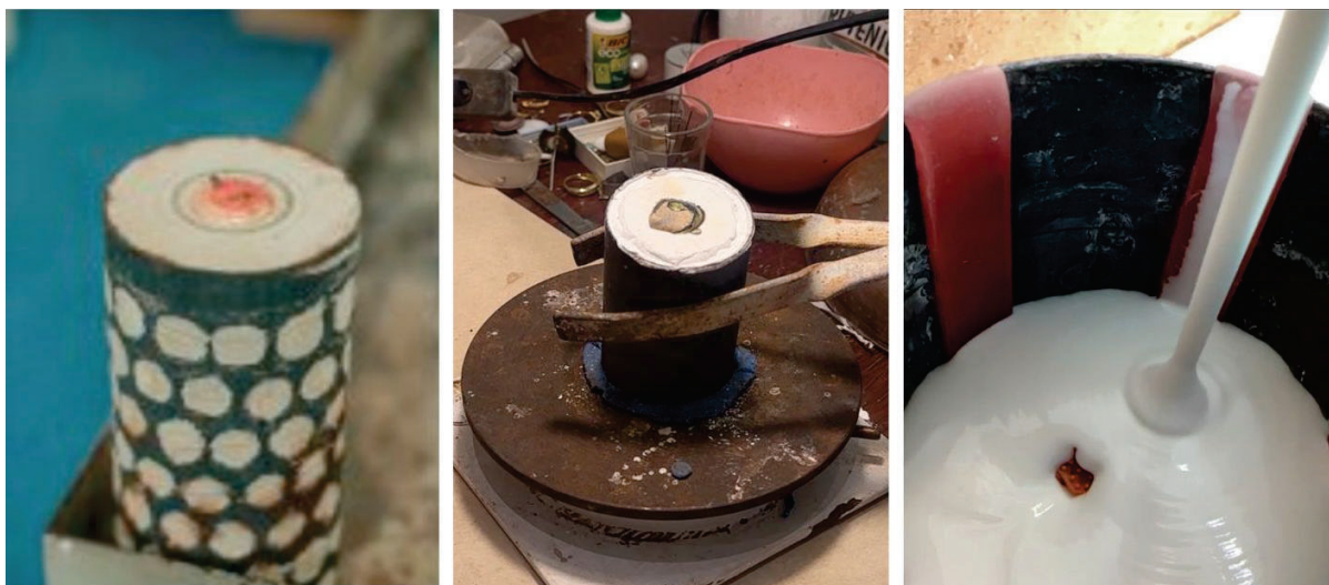
Figura 65 – Tubo perfurado, tubo liso na base de vácuo e detalhe dos canais de cera rosa dentro do tubo
