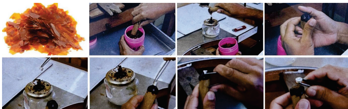
Figura 75 – Goma laca e bastão de cravação
