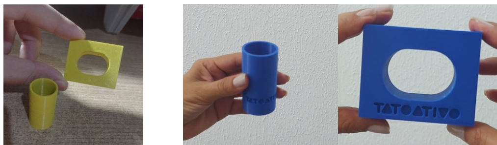
Figura 14 – (Esq.) Gabaritos NBR NM 300-1 em 50% do tamanho para testes preliminares. (Dir.) Os mesmos, em tamanho real.
