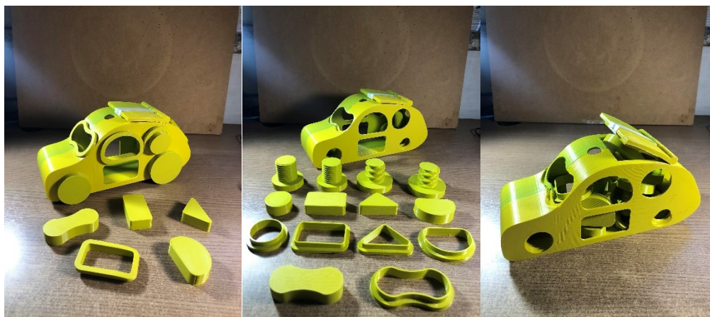
Figura 17 – Materialização em tamanho real através de impressão 3D.
