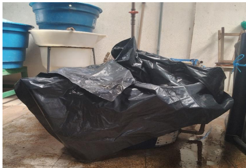
Figura 2- Tanque de maturação dos substratos coberto com lona escura.
