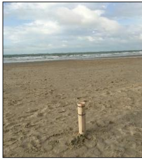
Figura 5 – Instalação do permeâmetro na face praial.
