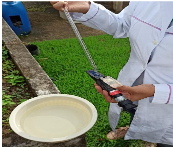
Figura 3 – Água estuarina coletada do canal do Mangue Seco, verificando a salinidade com um refratômetro modelo Q767-3 Quimis.
