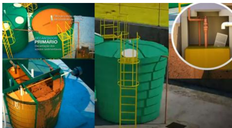
Figura 17 - Esquematização de estação compacta de tratamento
