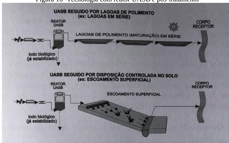
Figura 16 -Tecnologia com reator UASB e pós-tratamento
