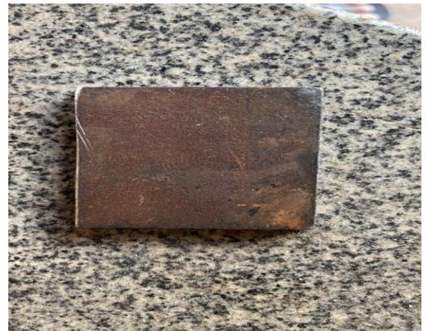
Figura 12 - Chapa de aço com carepa de laminação
