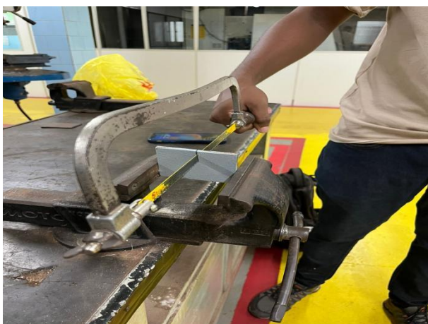
Figura 8 - Corte utilizando a serra
