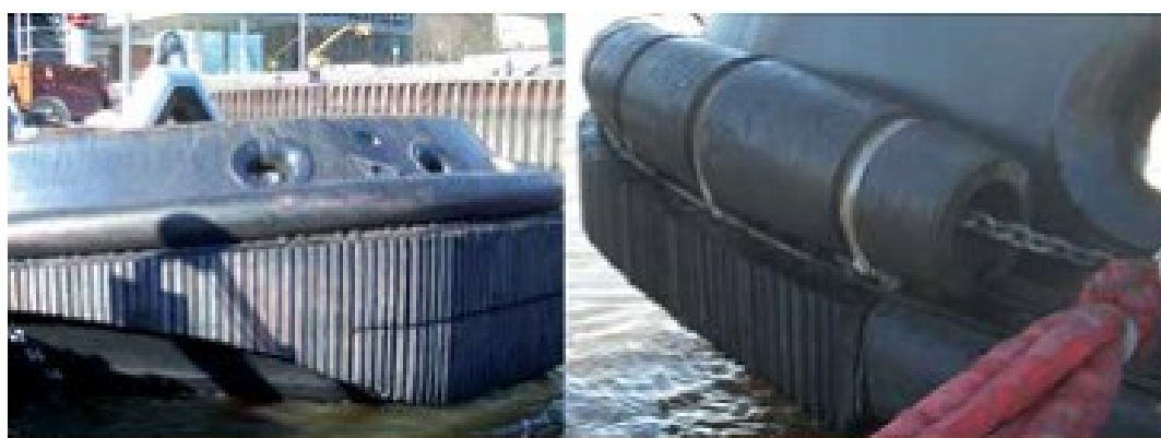
Figura 2 - Defensas para proteção de navios.
