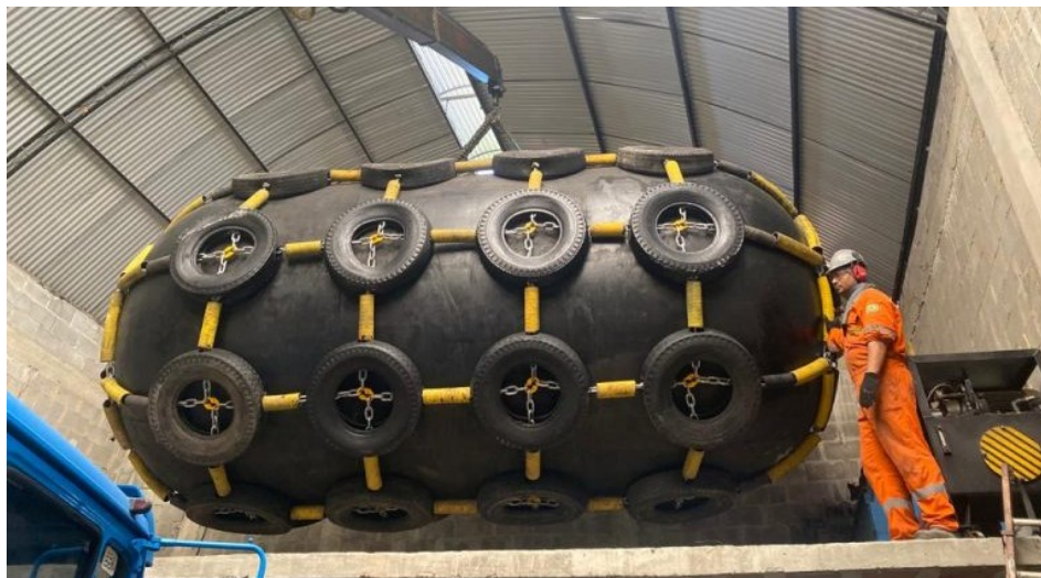
Figura 6 - Defensas pneumáticas com correntes e pneus.
