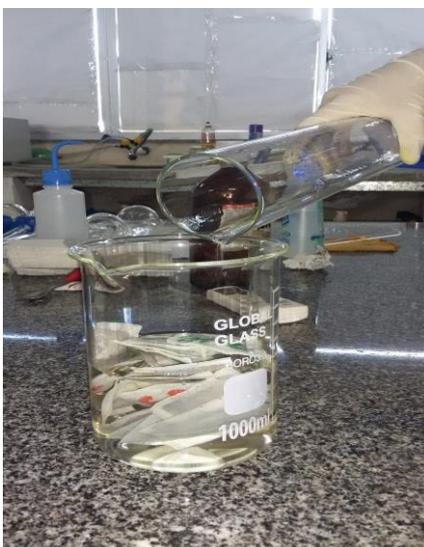
Figura 13: Adição de ácido sulfúrico as amostra para realização da lignina.
