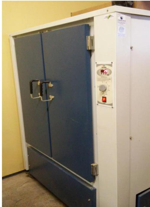
Figura 6: estufa de ventilação forçada de ar.
