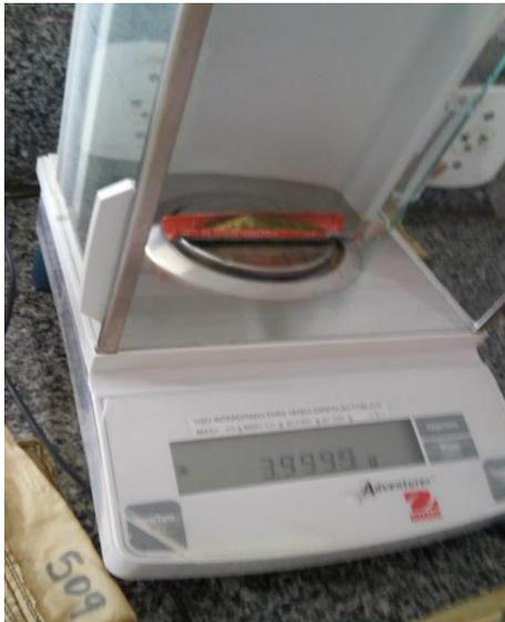
Figura 3: Pesagem de material para a realização da degradabilidade *in situ*.
