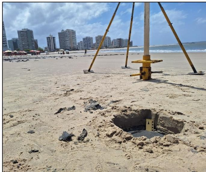
**Figura 2** – Equipamentos utilizados para sondagem a percussão. Fonte: Autor.
