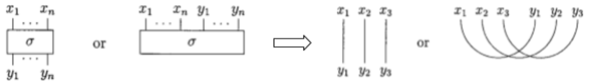
Figura 15 - Representação de um wiring
