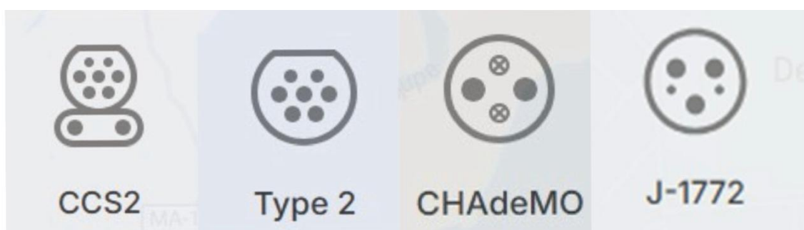
Figura 10 – Principais tipos de conectores.
