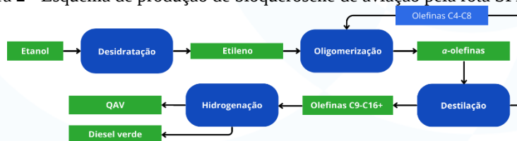
Figura 2 - Esquema de produção de bioquerosene de aviação pela rota SPK-ATJ.
