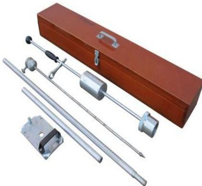
**Figura 2** - Penetrômetro de impacto IAA/Planalsucar – Stolf. FONTE: Kamaq
