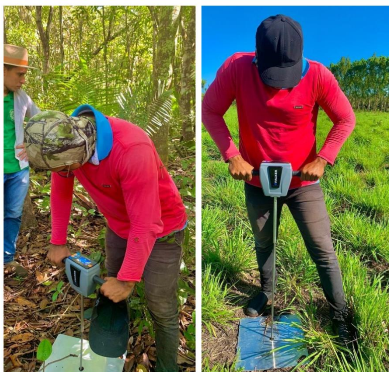
Figura 4 - Leituras da resistência mecânica à penetração na pastagem e na mata nativa.
