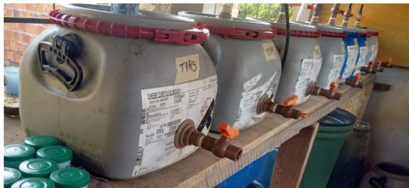
**Figura 2.** Modelos dos prototipos de biodigestores
