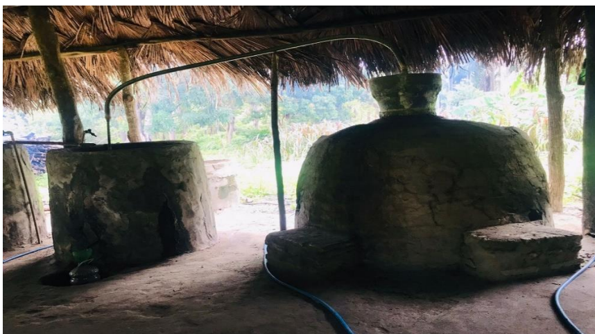
Figura 4: Alambique para a produção artesanal de Tiquira e Cachaça:
