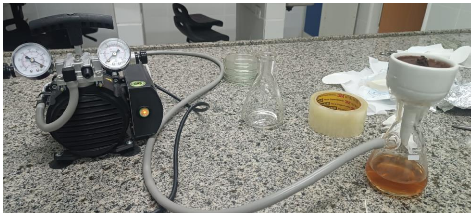
Figura 11 - Esquema de filtração a vácuo
