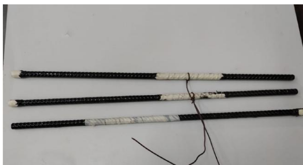
Figura 12 - Vergalhões recobertos com resina epóxi com uma região isolada.
