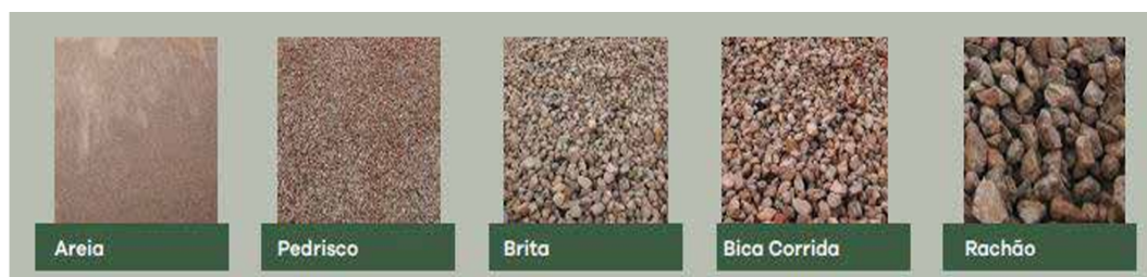
Figura 6 – Tipos de agregados reciclados produzidos na usina de RCC
