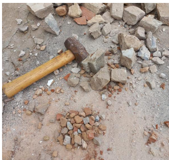
Figura 10 A - RCC triturado manualmente Figura 10 B - Amostra de RCC triturado
