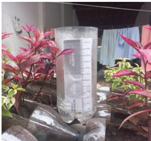
Figura 15 - Pluviômetro construído por garrafa pet.
