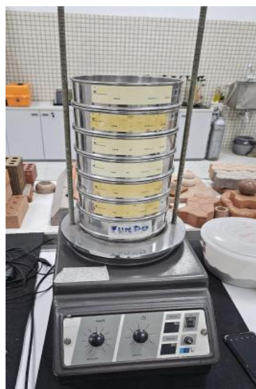
Figura 11 B - Etapa de peneiramento do RCC triturado
