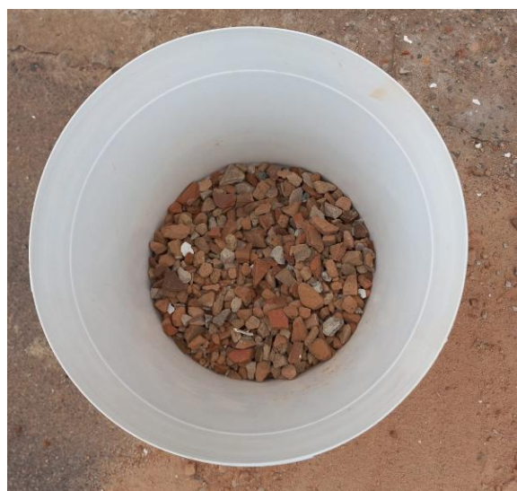
Figura 10 A - RCC triturado manualmente Figura 10 B - Amostra de RCC triturado
