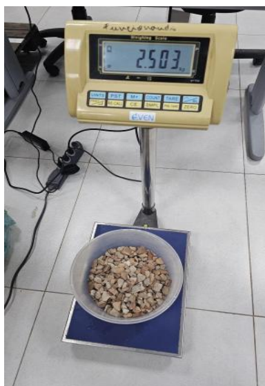
Figura 11 A - Etapa de pesagem da amostra de RCC triturado
