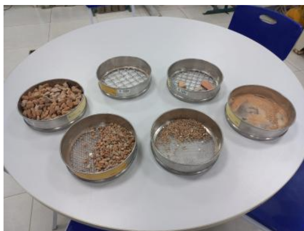
Figura 13 - Resultado após o peneiramento mecânico da amostra de RCC
