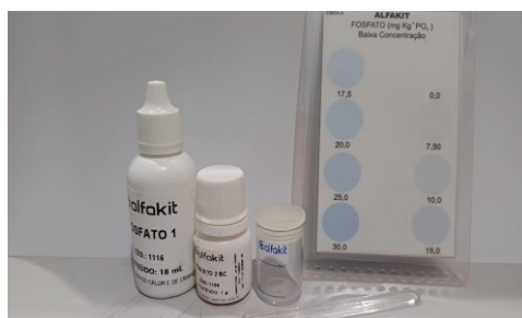
Figura 14 – Reagentes para determinação de fosfato e cartela de cores para interpretação dos resultados.
