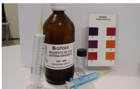
Figura 13 – Reagente utilizado na determinação de matéria orgânica e cartela de cores para leitura visual dos resultados.
