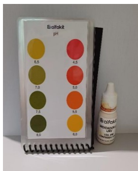
Figura 12 – Determinação do pH com reagente e leitura por cartela visual.
