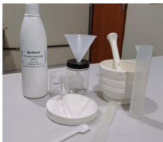
Figura 11 – Reagentes utilizados na extração para determinação de Fosfato e Potássio.
