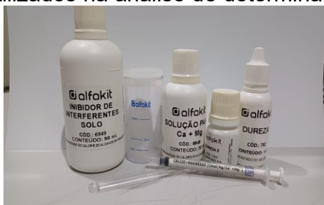
Figura 17 – Reagentes utilizados na análise de determinação de Cálcio + Magnésio.
