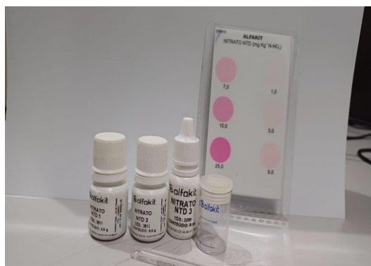
Figura 15 – Reagentes e cartela de cores utilizados na análise de nitrato ( \text{N-NO}_3^- ) pelo método NTD.
