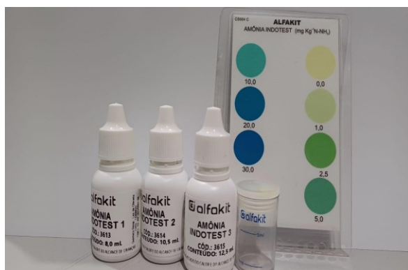
Figura 15 – Reagentes do método Indotest para análise de amônia ( \text{NH}_3 ) e cartela de cores utilizada na leitura dos resultados.
