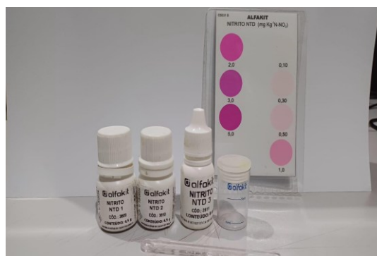
Figura 16 – Reagentes do método NTD para determinação de nitrito ( \text{N-NO}_2^- ) e cartela de cores correspondente.
