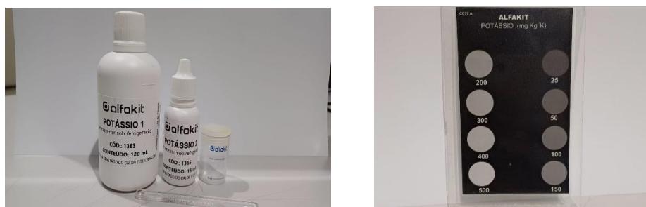
Figuras 19 e 20 – Reagentes e cartela de cores utilizados para a quantificação do potássio ( K^+ ) nas amostras.
