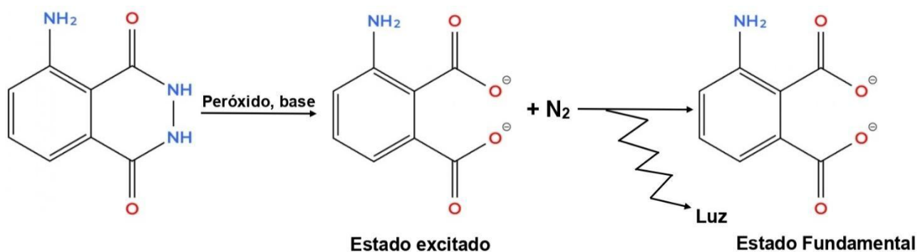
Figura 8: Mecanismo da reação quimiluminescente do luminol.
