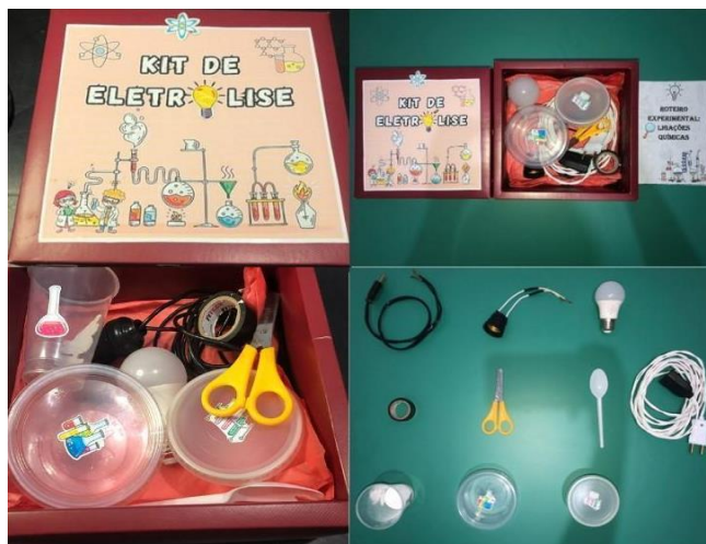
Figura 2 - Kit de eletrólise desenvolvido para atividade experimental.
