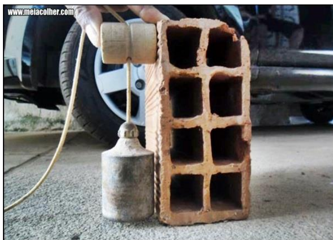
Figura 10: Forma correta de utilizar um prumo.
