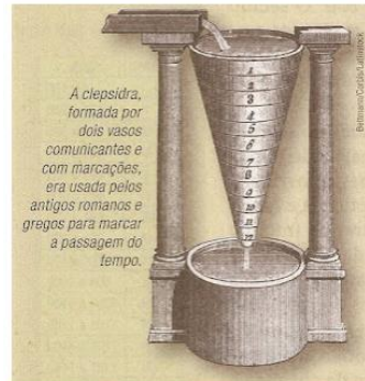
Figura 1 – Relógio hidráulico utilizado por Cetsébios de Alexandria
