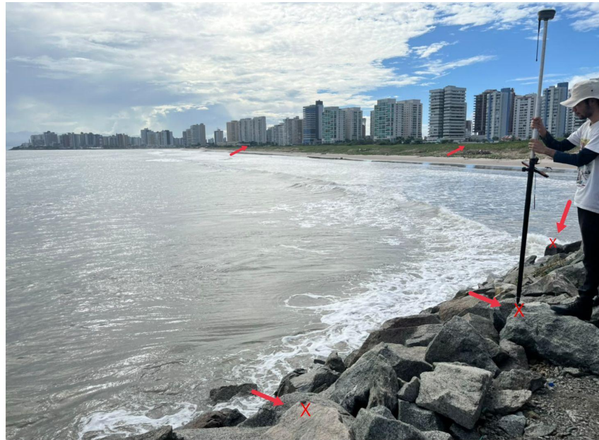
Figura 6: Coleta de pontos de controle fixos (GCPs) com equipamento GNSS, no Espigão da Ponta d' Areia , do dia 18/05/2026.
