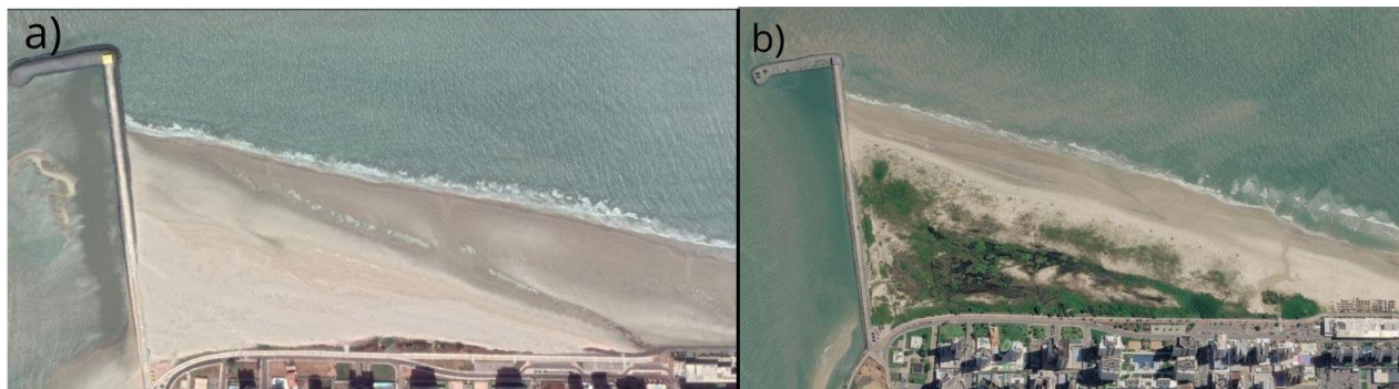
Figura 2 : Visão aérea oblíqua da orla da Ponta d'Areia em baixa-mar, evidenciando a evolução do Espigão Costeiro. (a) Cenário no ano de 2015; (b) Cenário no ano de 2026, destacando a consolidação do enrocamento.
