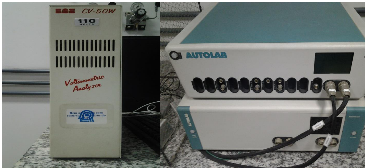
Figura 3 - Potenciostato CVW50 acoplado e interfaciado a um microcomputador (esquerda) e PGSTAT302N da Autolab Booster 20A Eco Chemie (direita).
