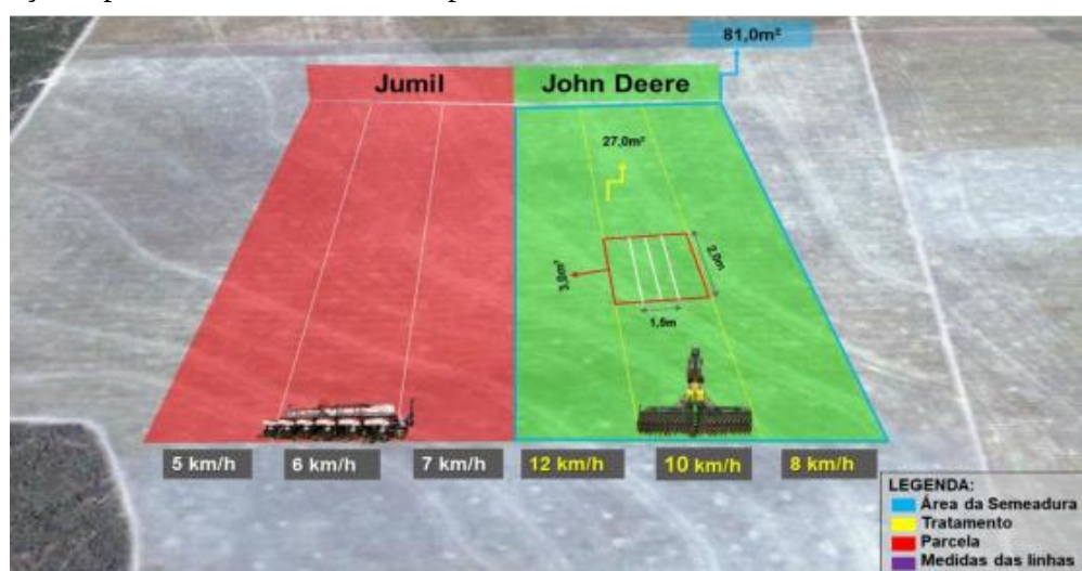
Figura 2. Croqui do delineamento experimental identificando as áreas de semeadura e as velocidades avaliadas.
